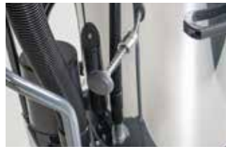
Filtro de paño y sacudidor de filtro manual que mantiene limpio el filtro gracias a un sencillo mecanismo manual con bisagras
