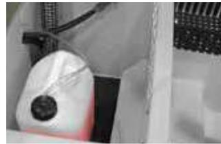
Système automatique de dosage de détergent (uniquement pour le modèle code : 37027-00089/37027-00090) Accès rapide au réservoir de récupération avec inspection visuelle. Accès et entretien facile des composants sans outils.
