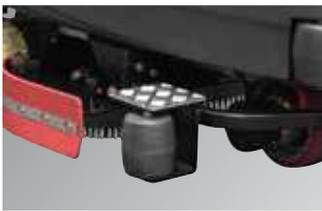
Nouvelle plaque de brosse de 1 000 mm pour augmenter la capacité de travail. Mise en œuvre du mode ECO pour la fonction brosse et aspiration afin de réduire la consommation d'énergie et le bruit. Kit Acquastop pour permettre le remplissage du réservoir de la solution sans risque de débordement. Accrochage et Décrochage automatique des brosses
