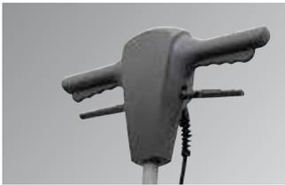
Poignée ergonomique avec commandes de sécurité intégrées
