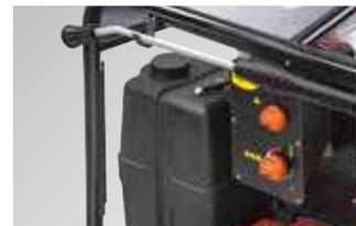
Contrôle flamme : arrête le fonctionnement à eau chaude en cas de dysfonctionnement du brûleur, en bloquant l'électrovanne diesel et en évitant l'encrassement de la chaudière à combustible imbrûlé. Il évite également que la flamme reste allumée même lorsque le brûleur est déjà éteint.
