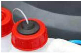
Autonomie illimitée grâce à l'alimentation en continu de la chaudière, qui permet le remplissage de l'eau dans le réservoir sans avoir à éteindre la machine et à interrompre le travail, avec un gain de temps considérable pendant la phase de fonctionnement. Chaudière 9 bar à 175°C avec vapeur saturée. Équipé de 3 pompes : chaudière, détergent et eau.
