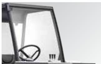
Toit de protection et cabine ouverte avec arceau de sécurité.
