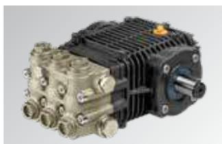
Nouvelle pompe CL 6.0 auto-amorçante à trois pistons en céramiques intégrale, roulements à rouleaux coniques, double visière à huile, tête en laiton nickelé et joints d'étanchéité à l'eau à haute température
