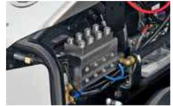
Pompe TW Premium 700 avec tête en laiton nickelé et pistons en céramiques
