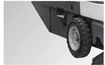
Direction avec direction hydraulique sur la roue arrière
