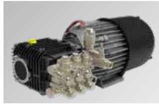
Nouvelle pompe CL 6.0 auto-amorçante à trois pistons en céramiques intégrale, roulements à rouleaux coniques, double visière à huile, tête en laiton nickelé et joints d'étanchéité à l'eau à haute température
