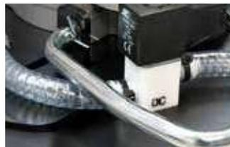
La distribution de la solution de nettoyage est contrôlée par une électrovanne. L'activation de l'électrovanne est actionnée par un levier de commande qui empêche la distribution de la solution de nettoyage lorsque la brosse est inactive pendant les interruptions de d'activité.
