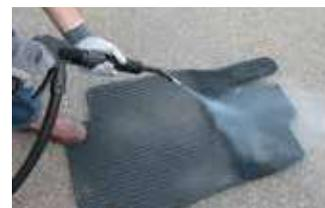
Kolumbo est un générateur de vapeur portable avec chaudière à mazout. Autonomie illimitée grâce au remplissage continu du réservoir d'eau. Ne laisse aucun résidu après le nettoyage. Économies d'eau (plus de 90 %) par rapport aux systèmes à haute pression normaux. Il permet des opérations de désinfection grâce à l'utilisation combinée de vapeur et de pression.
