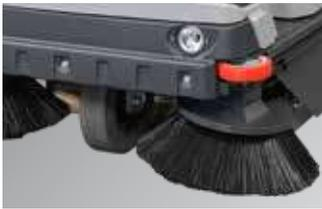
Brosse latérale droite et gauche Ø 50 mm 0 mm avec régulateur de vitesse (modèle DT), avec moteurs indépendants (modèle ET). Commandes électriques brosse latérale (modèle DT). Traction hydraulique sur roue avant (modèle DT). Traction électronique sur les 2 roues arrière (modèle ET)
