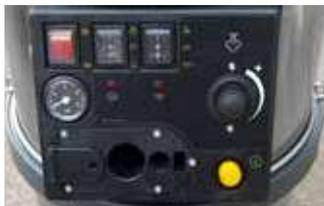
Nouveau panneau de commande simple et intuitif, attelage rapide pistolet à vapeur, sélecteur fonction vapeur/fonction air comprimé, sélecteur eau/détergent, régulateur débit vapeur, voyant vapeur prêt, voyant manque d'eau avec avertisseur sonore, manomètre vapeur et manomètre air.
