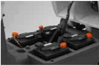
Le réservoir de solution de nettoyage sert également de compartiment à batteries, permettant le logement de batteries de grande capacité et garantissant une autonomie de travail optimale. Le réservoir en polyéthylène antichoc et anti-acide de grande capacité (110 l) améliore la productivité en réduisant les arrêts fréquents pour le remplissage
