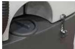
Le réservoir de la solution de nettoyage d'une capacité exceptionnelle de 300 litres et la grande autonomie des batteries assurent une productivité maximale du travail. La grande ouverture arrière permet un remplissage facile et rapide du réservoir de la solution de nettoyage.
