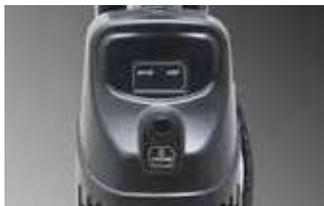
Les doubles brosses cylindriques contrarotatives offrent jusqu'à 40 % de performances de nettoyage en plus en un seul passage, augmentant ainsi considérablement la productivité. La machine dispose d'une poignée de sécurité pour l'allumage et l'extinction instantanés de l'autolaveuse.
