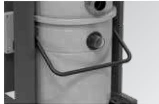
Secouer de filtre manuel qui maintient le filtre propre grâce à un mécanisme manuel à bascule simple
