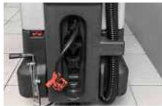
Chargeurs de batterie intégrés facilement accessibles, en position protégée contre les éclaboussures. Levage confortable de la raclette à pédale pour un gain de temps. Le timon peut être facilement réglé en hauteur pour un plus grand confort des opérateurs, même dans les espaces restreints.
