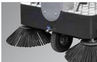
Système d'eau avant pour la réduction des poussières avec réservoir arrière de 2 l
