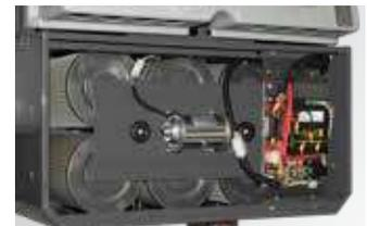
Grande surface filtrante répartie sur 6 filtres à cartouche équipés d'un secoueur de filtre électrique
