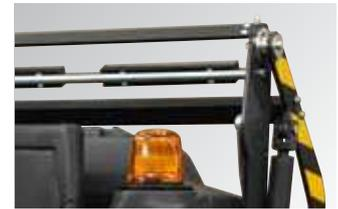
Système DSA : dispositif de vidange pour la vidange du réservoir dans des bacs à poussière jusqu'à 145 cm de hauteur.
