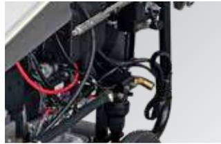
Moteur Kohler KDW 1003 refroidis à l'eau, 3 cylindres en ligne pour minimiser les vibrations
