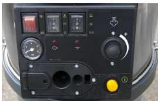
Nuovo pannello comandi semplice ed intuitivo, aggancio rapido pistola vapore, selettore funzione vapore/funzione aria compressa, selettore acqua/detergente, regolatore portata vapore, spia vapore pronto, spia mancanza acqua con segnalatore acustico, manometro vapore e manometro aria.
