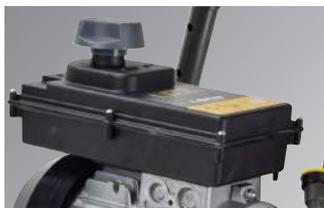
1 Motore ad induzione 4 poli (1400 rpm): la bassa velocità di rotazione allunga sensibilmente la vita dei componenti interni alla motopompa, garantendone una maggiore efficienza e silenziosità
