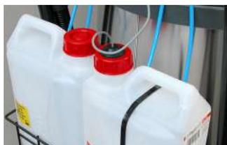
Autonomia illimitata grazie all'alimentazione in continuo della caldaia, che consente il rabbocco dell'acqua nel serbatoio senza dover fermare la macchina o interrompere il lavoro. Tubo di scarico per svuotamento rapido del deposito di raccolta acqua sporca senza dover rimuovere la testata.
