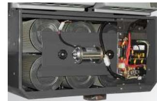
Ampia superficie filtrante distribuita su 6 filtri a cartuccia dotati di scuotifiltro elettrico
