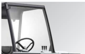
Tettuccio di protezione e cabina aperta con roll-bar.
