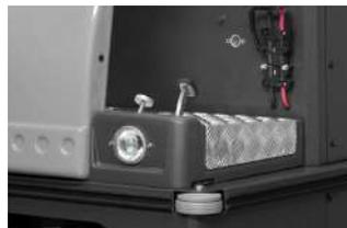
Pannello di controllo con: sistema di spegnimento aspirazione, indicatore livello batteria (modello ET) e tasto on/off. Luce lampeggiante
