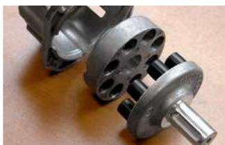
Giunto elastico incorporato per un migliore accoppiamento pompa/motore
