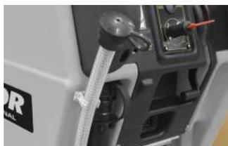
Dispositivo di regolazione del detergente. Tubo di scarico del serbatoio di recupero con regolazione di flusso. Sistema automatico per il sollevamento spazzole (solo modello 66BTA).
