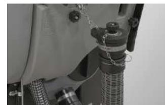
Robuste leve di controllo meccaniche per uso intensivo. Tubo di scarico di grandi dimensioni per uno svuotamento rapido e una migliore pulizia del serbatoio di recupero. Attacco rapido per caricabatteria.
