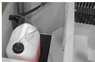
Sistema automatico di dosaggio detergente (solo per modello codice: 37027-00089/37027-00090) Accesso rapido al serbatoio di recupero con ispezione visiva. Facile accesso e semplice manutenzione dei componenti senza l'ausilio di attrezzi.
