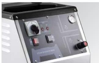
Nuovo pannello di controllo con: Interruttore generale ON/OFF, interruttore caldaia ON/OFF, selettore del detergente, selettore acqua calda, spia riserva acqua, spia del pronto vapore, regolazione del vapore, manometro
