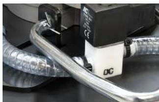
L'erogazione della soluzione detergente è controllata da un'elettrovalvola. L'attivazione dell'elettrovalvola è azionata da una leva di controllo che impedisce l'erogazione della soluzione detergente quando la spazzola è inattiva durante le interruzioni dell'attività.
