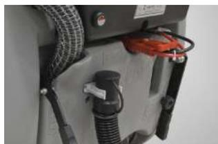
Leva di controllo per attivazione spazzola e flusso soluzione detergente. Tubo di scarico del serbatoio di recupero. Spina caricabatteria ad innesto rapido.
