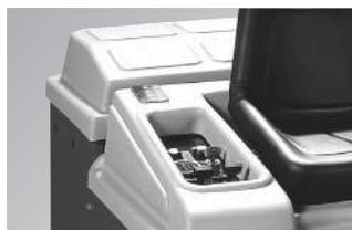
Pannello di controllo con sistema di spegnimento aspirazione, indicatore livello batteria (modello ET) e tasto on/off
