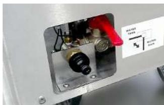
Autonomia illimitata grazie all'alimentazione in continuo della caldaia, che consente il rabbocco dell'acqua nel serbatoio senza dover spegnere la macchina o interrompere il lavoro, con notevole risparmio di tempo in fase operativa. Caldaia a 10 bar alla temperatura di 180°C con vapore saturo. Dotato di 2 pompe: detergente e acqua. Massima sicurezza grazie ai 2 controlli di livello, 2 termostati, 1 pressostato e 1 valvola meccanica di massima pressione.
