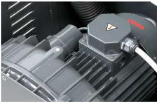
Motore a turbina silenziato IP 55 e valvola limitatrice di pressione
