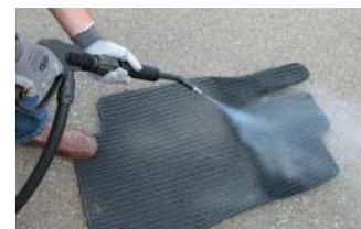
Kolumbo è un generatore di vapore portatile con caldaia a gasolio. Autonomia illimitata grazie al riempimento in continuo del serbatoio dell'acqua. Non lascia residui dopo la pulizia. Risparmio idrico (oltre il 90%) rispetto ai normali sistemi ad alta pressione. Consente operazioni di sanificazione grazie all'utilizzo combinato di vapore e pressione.
