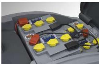
Accesso rapido al vano batteria e motore aspirazione senza l'ausilio di strumenti. Serbatoio in polietilene antiurto e antiacido di grande capacità (88 l) che evitano frequenti soste per il riempimento. 4 batterie x 6 V -180 Ah C5 che garantiscono un'autonomia di lavoro continuativa fino a 4-5 ore.
