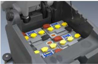
Grande autonomia di lavoro grazie alla possibilità di utilizzare 4 batterie 6 V 180 Ah che garantiscono un funzionamento in continuo. Possibilità di utilizzare anche 2 batterie 12V. Minore consumo della batteria grazie alla trazione posteriore. Serbatoio di grande capacità in polietilene antiurto e anticiduro (carico effettivo 85 l.) che evitano soste frequenti per il riempimento.
