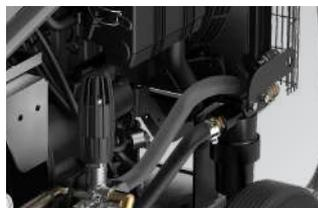
Motore Kohler KDW 1003 raffreddato ad acqua, 3 cilindri in linea per ridurre al minimo le vibrazioni
