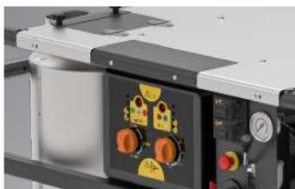
Quadro spie motore con avviamento elettrico, contaore e regolazione manuale del numero di giri, quadro caldaia con interruttore attivazione bruciatore e regolazione elettronica della temperatura
