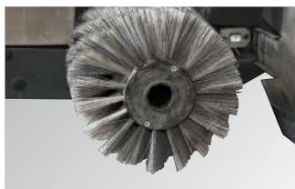
Robusta e grande spazzola centrale d.300 autolivellante a pressione regolabile e rotazione antioraria. Gruppo spazzola in acciaio inox. Innovativo sistema AIR RECOVERY (brevettato): grazie all'aria compressa convogliata davanti alla spazzola, si evita la dispersione laterale della soluzione detergente.
