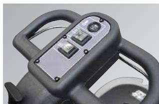
Pannello di comandi analogico semplice ed intuitivo. Leva di comando per azionamento spazzola ed erogazione soluzione detergente. Interruttore generale ON/OFF, interruttore motore spazzola e aspirazione, interruttore attivazione elettrovalvola.
