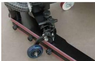
Il robusto tergilavaggio a V in profilo di acciaio è ampiamente regolabile e permette di combinare il funzionamento delle lame in gomma con l'elevata potenza di aspirazione, per ottenere un risultato di asciugatura perfetto su ogni superficie. Lo speciale filtro trattiene le impurità ed evita l'ostruzione del tubo di aspirazione.
