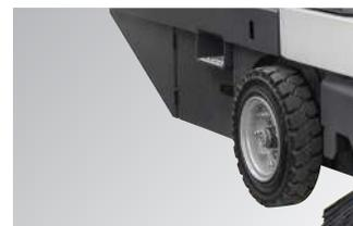
Sterzo con idroguida sulla ruota posteriore
