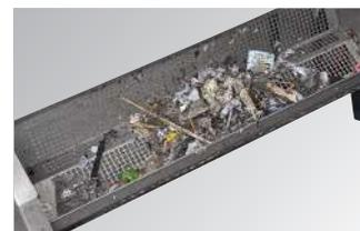
Ampio serbatoio di raccolta in acciaio inox da 30 lt che permette la raccolta dei detriti solidi.
