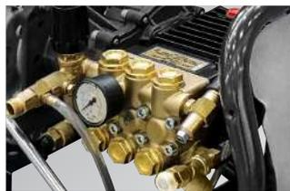
Nuova pompa CL 6.0 autoadescante a tre pistoni in ceramica integrale, doppio visore olio e testata in ottone. Riduttore di giri tra motore e pompa. Nuova valvola di regolazione pressione flangiata L3.1, passaggi interni ridimensionati per garantirne il corretto funzionamento anche in condizioni di alte portate d'esercizio
