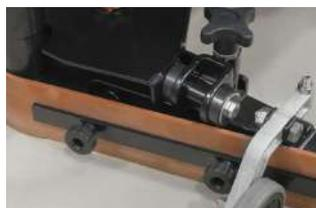
Il resistente tergipavimento a V garantisce una perfetta asciugatura su ogni tipo di pavimento, anche con fughe larghe. Le ruote antitraccia evitano segni dopo l'asciugatura. Completamente adattabile a qualsiasi superficie.
