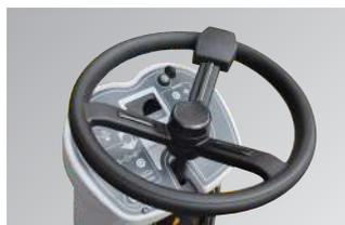
Nuovo pannello di controllo con comandi e display digitali. Display digitale con contatore, indicatore livello di carica della batteria, spia serbatoio vuoto e indicatore di trazione avanti/indietro. Regolazione velocità, clacson, interruttore motore aspirazione con spegnimento ritardato,
