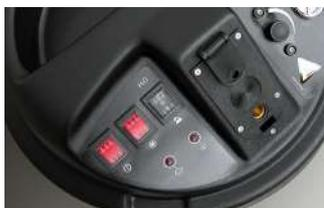
Pannello comandi semplice ed intuitivo, aggancio rapido pistola vapore, selettore acqua/detergente, regolatore portata vapore, spia luminosa di indicazione di vapore pronto, spia luminosa di mancanza acqua con segnalatore acustico, manometro vapore. Pistola vapore con tasto attivazione funzione vapore/detergente integrato e attacco rapido degli accessori.
