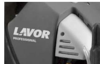
Serbatoio detergente integrato nel telaio della capacità di 7,5 litri per aspirazione indiretta del prodotto chimico
