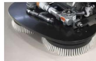
Resistente piatto spazzole monoblocco in acciaio da 1.5 mm per impieghi gravosi. Grande pressione sul pavimento per una pulizia profonda anche sullo sporco più ostinato. Sistema autolivellante. Elettrovalvola per interruzione dell'erogazione del detergente durante le interruzioni delle fasi di lavoro.
