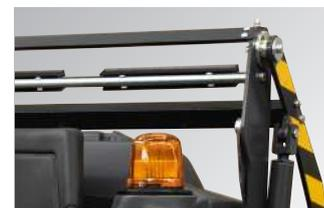
Sistema DSA: dispositivo di scarico per lo svuotamento del serbatoio in contenitori polveri fino a 145 cm di altezza.
