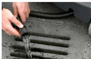
Sistema scarico liquidi per vuotare in maniera veloce il fusto dai liquidi aspirati
